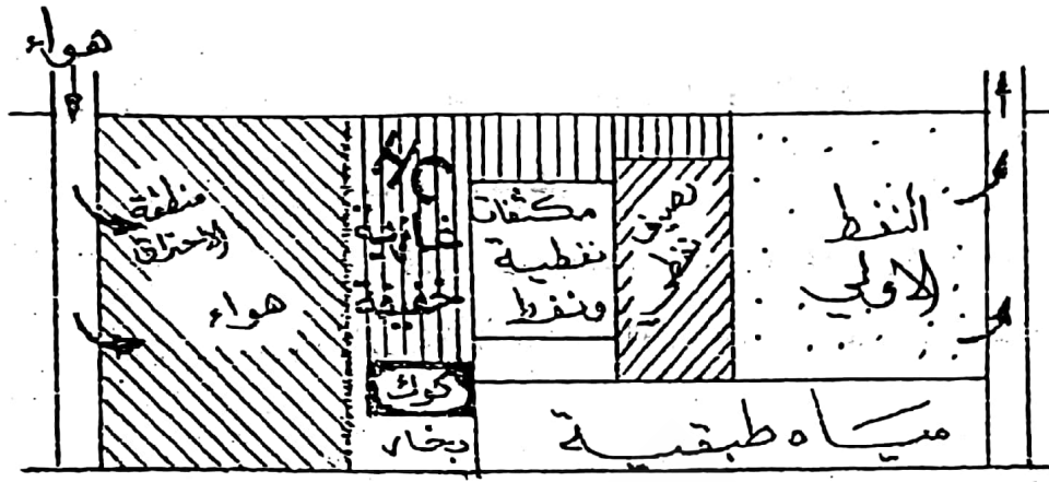
شكل (6-6) يبين عملية الحرق في الطبقة
